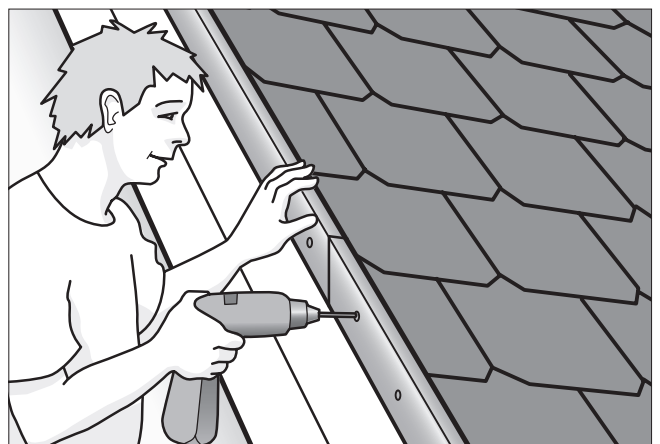
Fastgør løse inddækninger.
